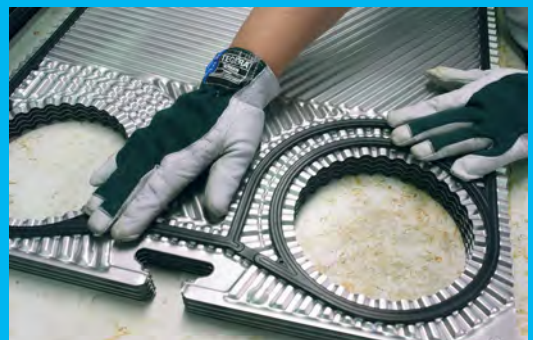
Huolto palauttaa heikentyneen lämmönsiirtotehon.
